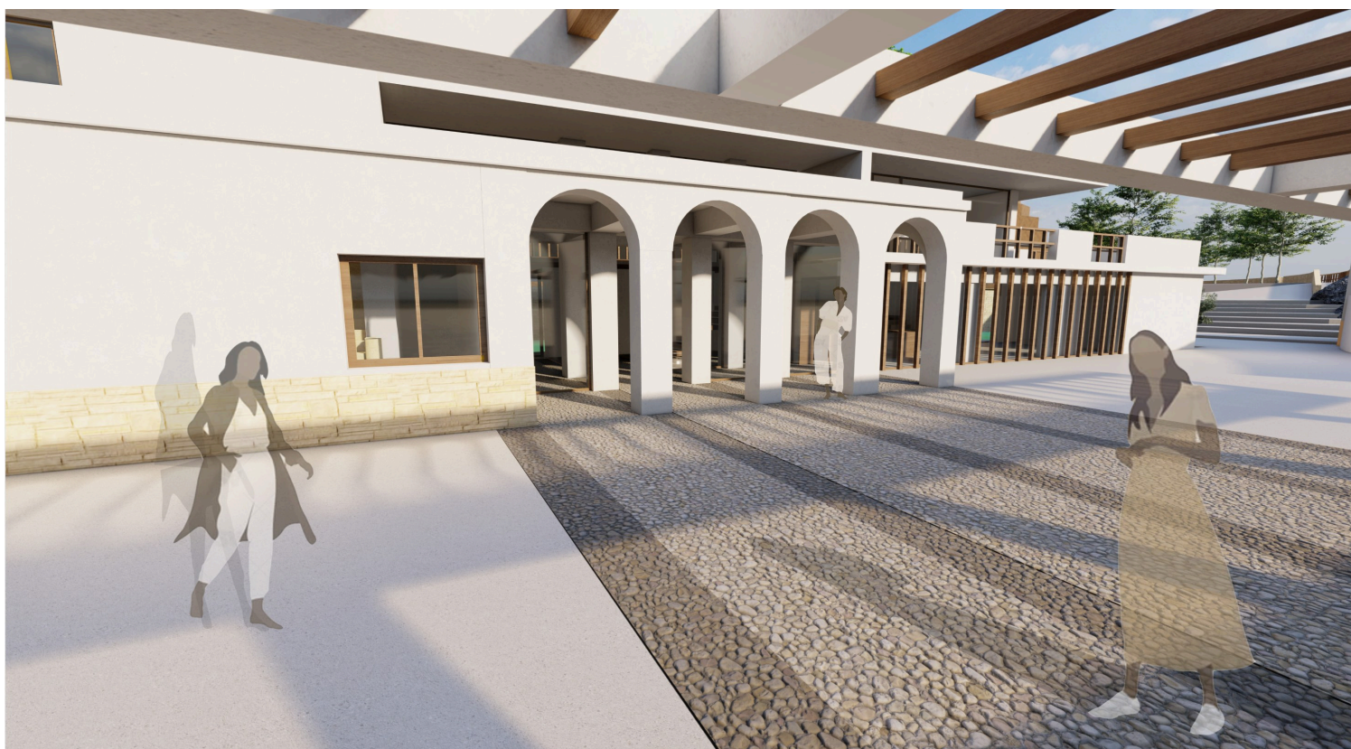
Αποκατάσταση του τοξωτού προστώου και βοτσαλωτό δάπεδο
