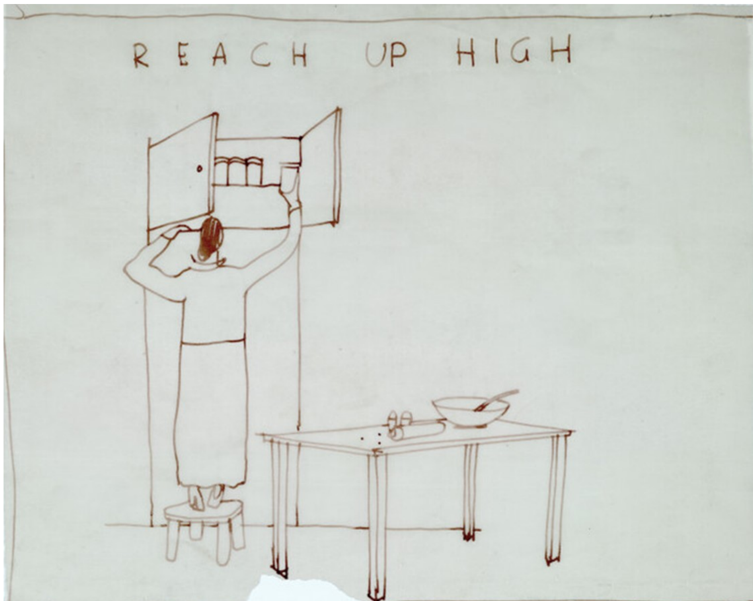
Gordon Cullen, σκίτσο για ντουλάπι έκθεσης κουζίνας που διερευνά σχεδιαστική επίλυση για το κατάλληλο ύψος εξοπλισμού που θα επιτρέπει την ίση πρόσβαση και χρήση μιας κουζίνας από ηλικιωμένα άτομα και άτομα με αναπηρία, c. 1936 (RIBA Collections)
